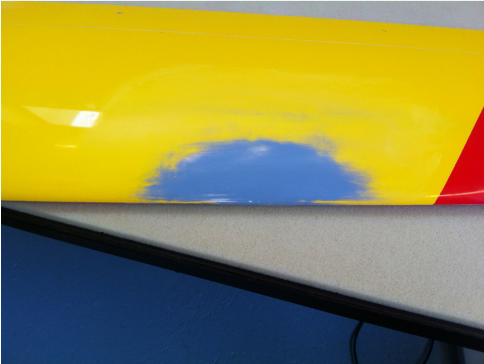
Oberseite, fertig zum Abdecken
