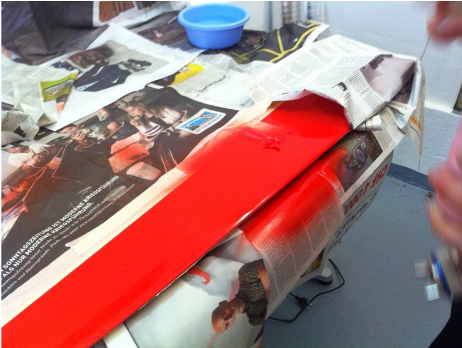
Abdeckung auf einer Seite bereits entfernt und wie beschrieben mit Verdünner und Restfarbe 'ausspritzen' IMG_1430.jpg (151.44 KiB) 2933-mal betrachtet
