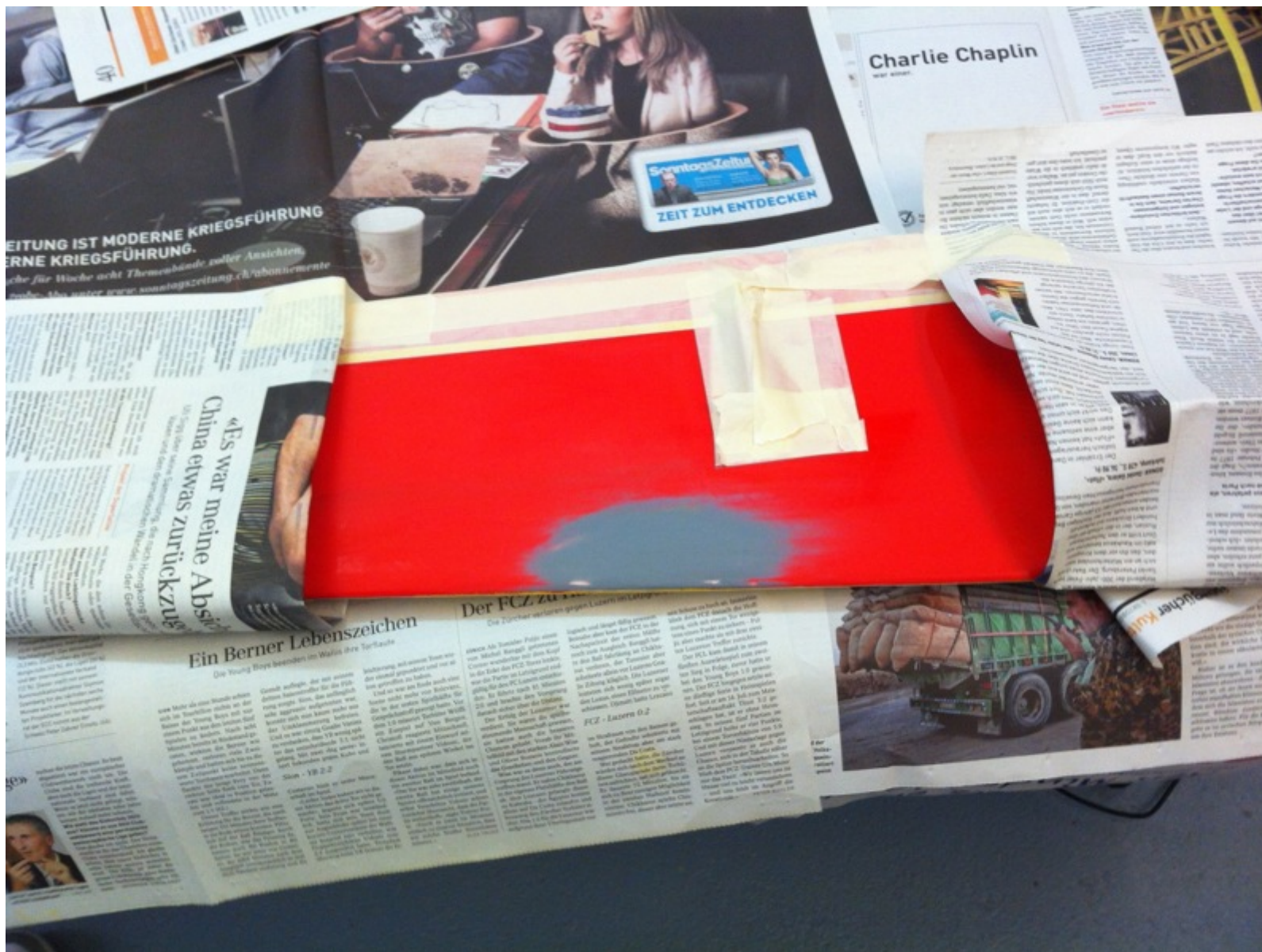
Grundierung schleifen und entsprechend abdecken IMG_1421.jpg (160.39 KiB) 2933-mal betrachtet
