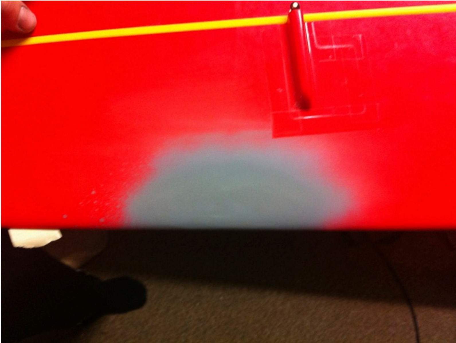
Unterseite grundiert, Abdeckungen wieder entfernt IMG_1389.jpg (81.59 KiB) 3621-mal betrachtet
