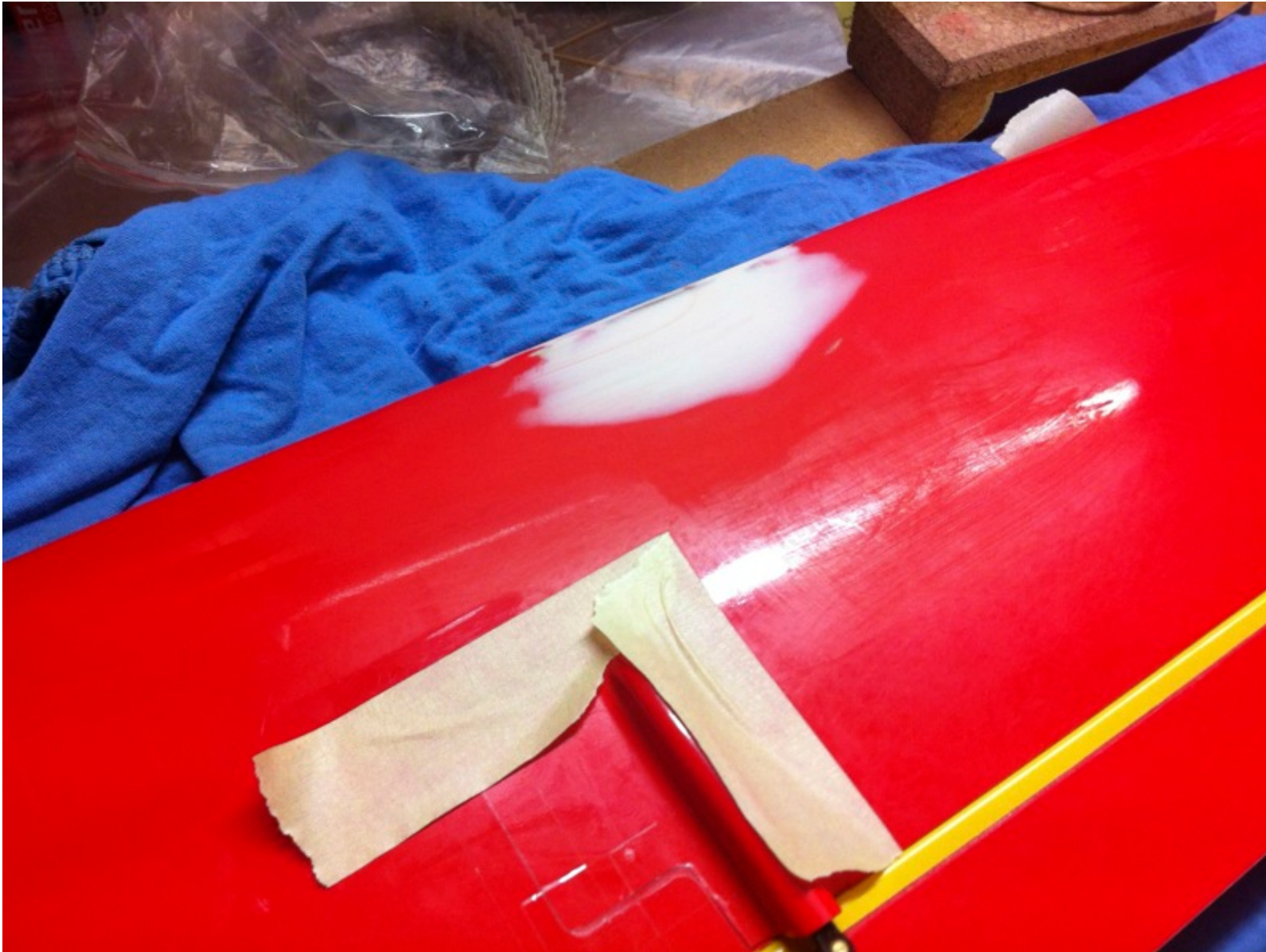
Unterseite fertig verschliffen, Farbe angeraut, Teile abgedeckt, damit sie keine Grundierung abkriegen IMG_1388.jpg (124.05 KiB) 3620-mal betrachtet
