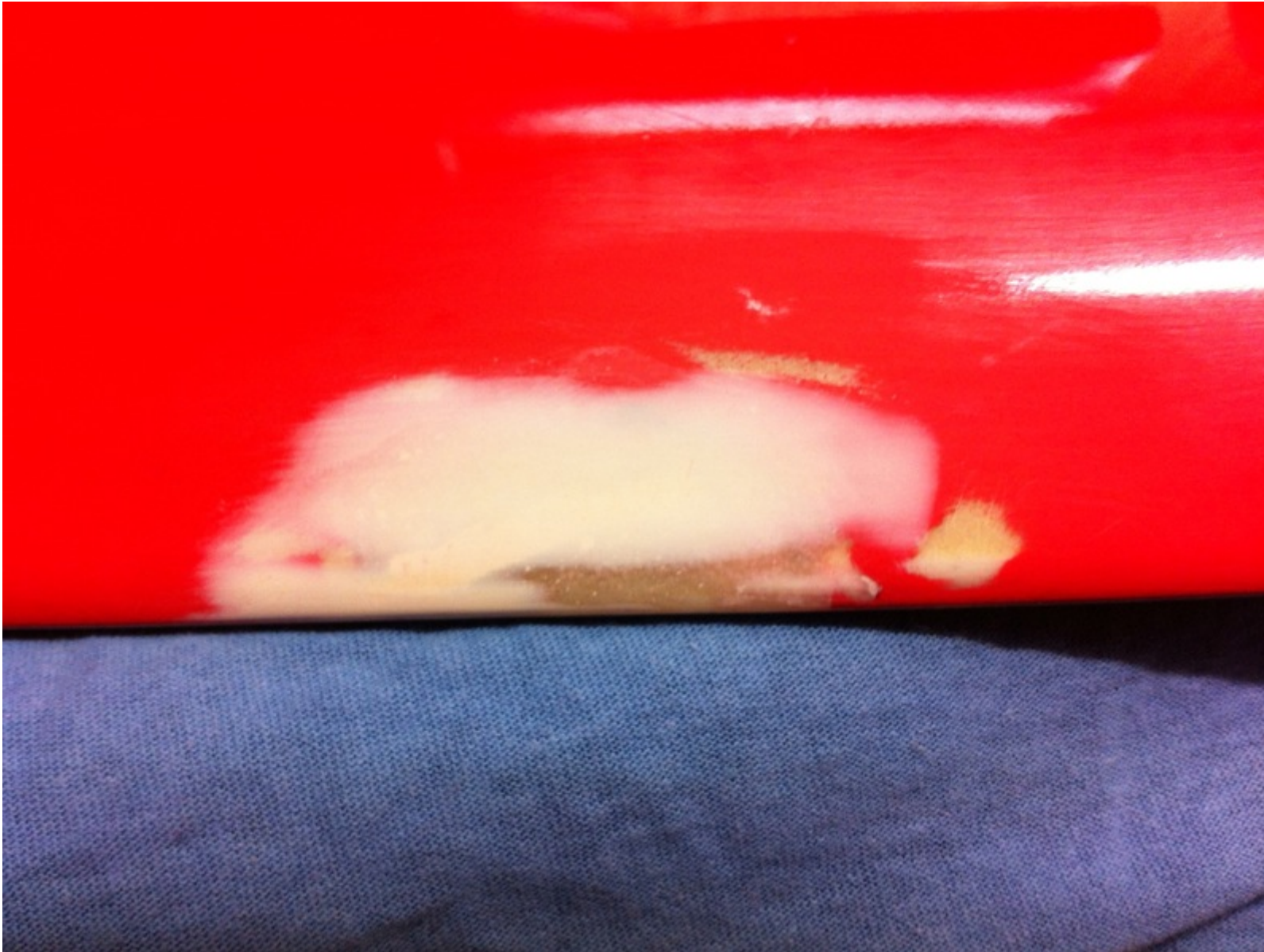
Unterseite 1. Mal gespachtelt und verschliffen IMG_1385.jpg (122.49 KiB) 3620-mal betrachtet
